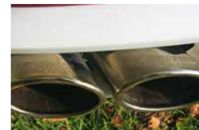
Ovale Edelstahl-Blenden für die Auspuffrohre fügen sich vollendet in die Öffnungen des Heckschürzenansatzes ein.
