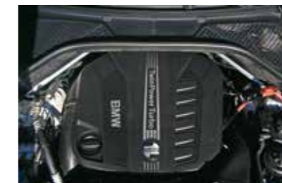
Mittels eines Zusatzsteuergeräts steigert Kelleners die Leistung des Dreiliter-Diesellaggregats auf mehr als 300 PS.
